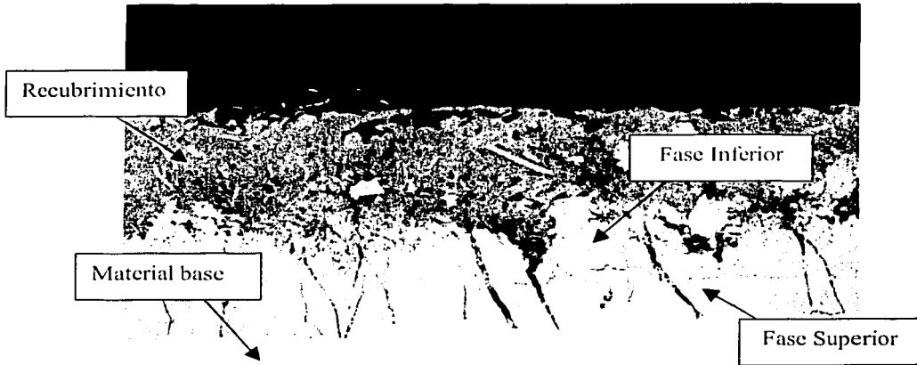
Fig. 4.5. Imagen 35.1 a 500x (Electrones retrodispersados). Vista General. Recubrimiento, capa intermetálica y material base. Aluminio sobre Acero 1018 por inmersión en caliente. Aluminizado. Probeta enfriada en agua.
