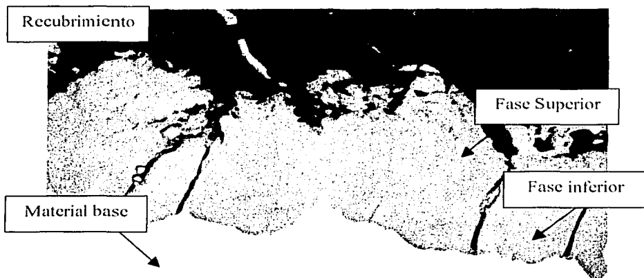
Fig. 4.16. Imagen 41.3 a 1500x (Electrones retrodispersados). Vista general. Recubrimiento, capa intermetálica y material base. Aluminio sobre Acero 1018 por inmersión en caliente. Probeta enfriada al medio ambiente, recocida 1 hr a 550°C y laminada 20% a 300°C.
