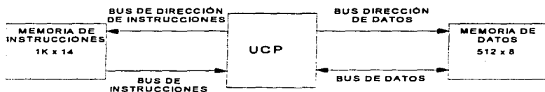
Figura 2.3 En la arquitectura Harvard la memoria de instrucciones y las de datos son independientes, lo que permite optimizar sus características y propiciar el paralelismo. En la figura, la memoria de instrucciones tiene 1K posiciones de 14 bits cada una, mientras que la de datos sólo dispone de 512 posiciones de un byte.
