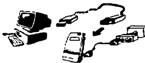
Figura 5.17. Conexión del Módem ADSL al puerto USB de la PC
