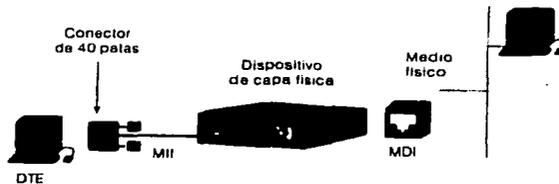
Figura 1.27 100BaseT requiere varios componentes de hardware.
