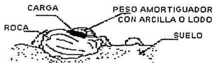
Fig. 87: Método de la carga externa.
