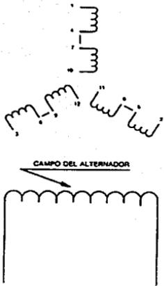
Figura II-8a Bobinas del alternador incluyendo el campo de la excitación.
