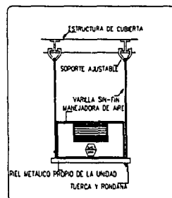
DETALLE DE SOPORTERIA PARA AUA
