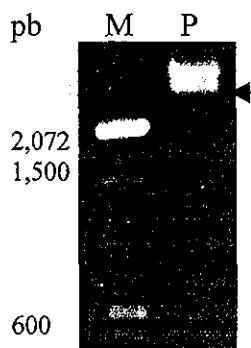
Fig 11. Digestión del plásmido pRSET vw7-3 con las enzimas EcoRI y HindIII . pb, pares de bases, M marcador de peso molecular 100bp, P plásmido pRSET vw7-3 digerido. La flecha indica el fragmento de 2,600 pb que corresponde a la región codificadora completa de la TPmy.
