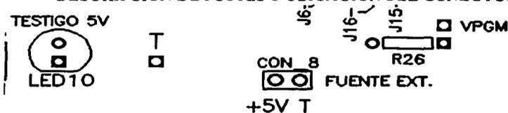
**Nota:** Si la tarjeta FACIL\_11 se energiza por el conector 8 esto deberá hacerse desde una fuente de 5 volts respetando la polaridad indicada, en caso de invertirse la polaridad podrían originarse daños irreversibles a la tarjeta; además el jumper J27 no deberá estar colocado.
