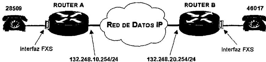
Figura 7-1: Comunicación telefónica sobre una red de datos IP (usando dial-peers).
