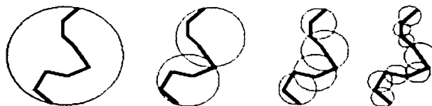
Figura (13) La geometría de ejemplo es una colección de segmentos de línea. La esfera de mayor nivel cubre toda la geometría. En el siguiente nivel, dos esferas cubren cada una la mitad de los segmentos. En cada etapa, las primitivas cubiertas por cada volumen envolvente también están cubiertas por la unión de los volúmenes envolventes que son hijos del volumen envolvente en cuestión. En los nodos de menor jerarquía los volúmenes envolventes cubren sólo una primitiva. Los volúmenes hijo pueden traspasar el volumen que encierra el padre y entre nodos hermanos pueden traspasarse
