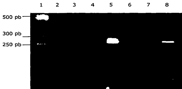
Figura 13. Análisis de productos de amplificación del Promotor 35S utilizando en un gel de agarosa (2%): Marcador de peso molecular 50 pb. (1), Control negativo sin ADN (2), Eje embrionario de maíz criollo control negativo (3), Mazorca congelada (4), Grano cocido enlatado (5, 6, 7), Control certificado Harina de maíz Bt176 Fluka (8). Se cargaron 7 \mu L de cada muestra.
