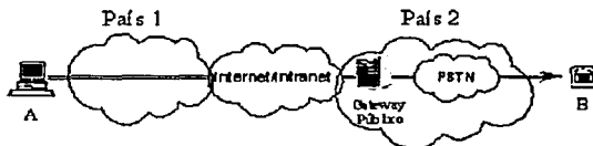
Fig. 2.4 Esquema de conexión internacional PC a teléfono fuera de la corporación
