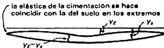
f) Comparación de asentamientos diferenciales de suelo y cimentación
