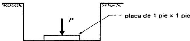
a) Esquema de la prueba de placa
