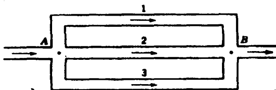
Figura 5.26 Sistema de tubería en paralelo.
