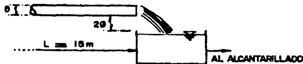
Figura 4.7 Tubo de desagüe para limpieza del tanque.
