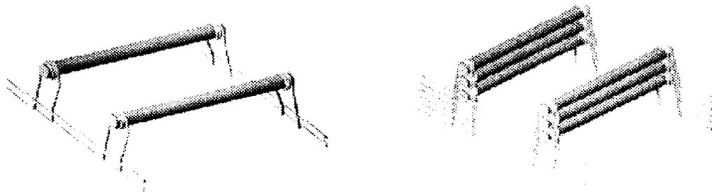
Figura 3.52 Tipos de presentación de las barras de unión FRP para pavimentos
