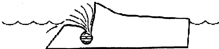
IMAGEN 23: WavePlane. Dispositivo para generar energía eléctrica a partir de las olas
