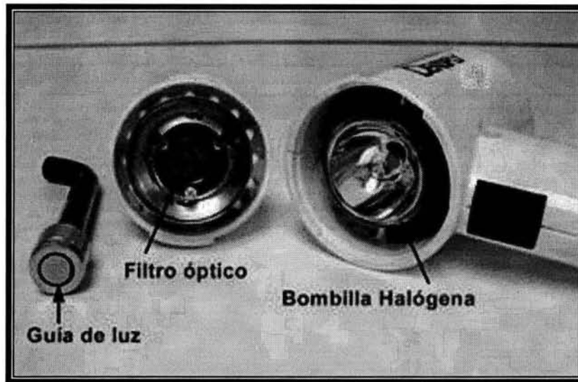
Fig. 22. Que muestra algunos de los componentes de una lámpara halógena incluyendo el filtro.
