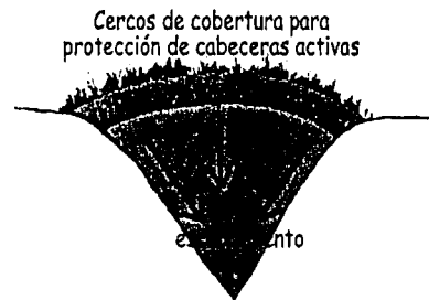
Figura 21: Cercos de cobertura sobre las cabeceras que presentan erosión.
