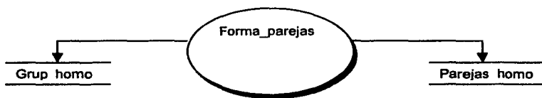
Fig. 25 D.F.D. de la Formación de Parejas del Subsistema de Detección de Registros Duplicados.
