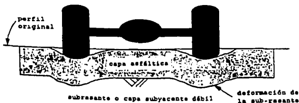
FIGURA 3 - 8 AHUELLAMIENTO DE UNA SUBRASANTE DÉBIL
