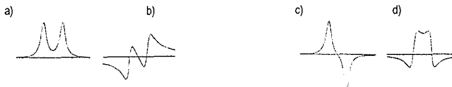
Figura 13 Formas de la señal en un espectro de RMN cuando existe acoplamiento a) señal en fase modo de absorción b) señal en fase en modo de dispersión c) señal en antifase en modo de absorción d) señal en antifase en modo de dispersión
