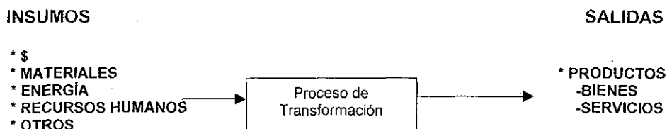
Figura 1.1 Representación básica del proceso de producción como sistema
