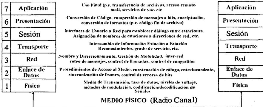
Figura 5.1. Estructura Funcional del Modelo OSI
