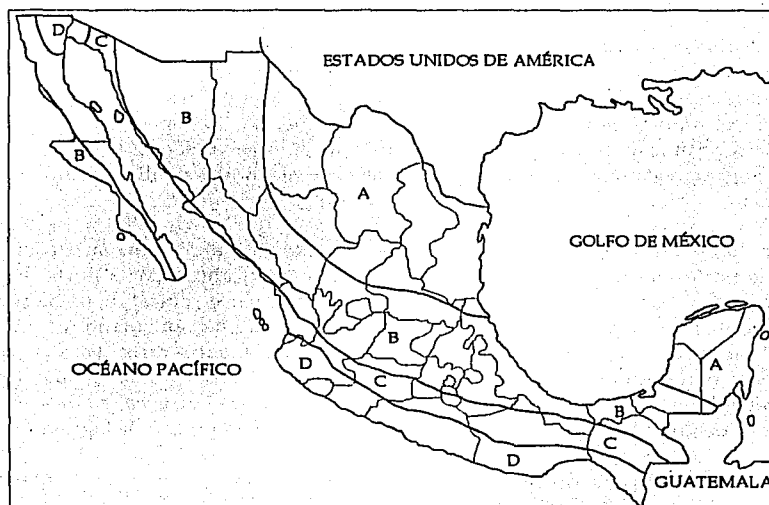
Figura III.1.1. Regionalización sísmica de México.
