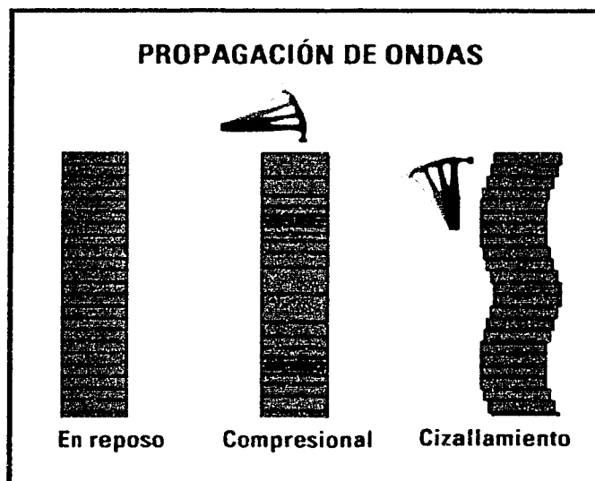
Fig 1 2 Muestra el comportamiento en la propagación de las ondas Nótese la dirección de propagación de las ondas con relación al movimiento de las partículas Figura tomada y modificada del PEPTEC-Online-Wireline-Acoustics-Sonic-DSST 1
