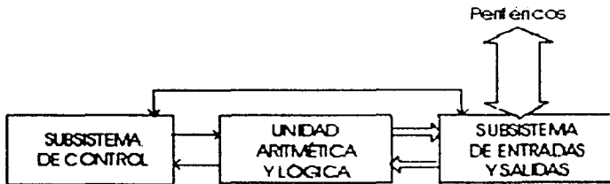
Figura 2.2. Diagrama de bloques de un microprocesador.
