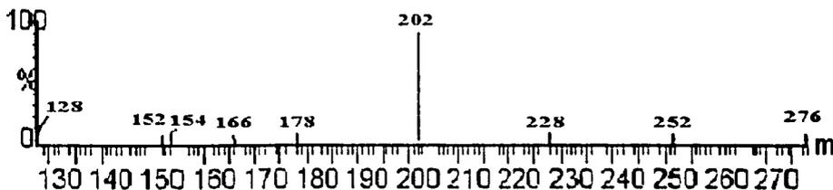
Figura 4.7 Espectro de masas correspondiente al fluoranteno identificados en una muestra de ostiones
