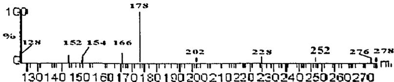
Figura F.6 Espectro de masas correspondiente al Fluoranteno identificados en una muestra de ostiones
