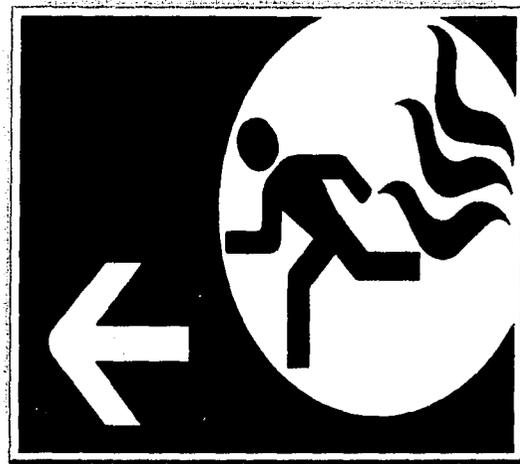
Diseño final de señalamiento de ruta de evacuación, que será utilizado en soportes para colgar del techo y para adosar a la pared.
