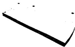
La tapa del techo está formada por una lámina de acero calibre 20, cortada, barrenada, rolada y doblada.
