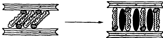
Fig. 32 Representación esquemática de la intercalación de una arcilla modificada con iones de alquilamonio, por moléculas poliméricas. [32]
