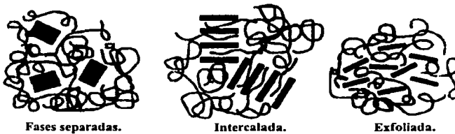
Fig. 22 Esquema de los tres tipos posibles de morfologías de nanocompuestos polímero-arcilla. [33]
