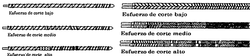
Fig. 36 Ejemplos de tipos de husillos utilizados en un proceso de extrusión; un husillo en el lado izquierdo y doble husillo en el derecho. [72]
