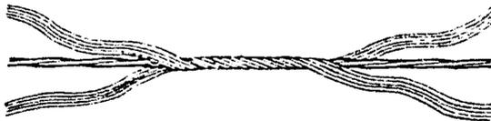
4.- Sujete todas las varillas y con el mismo movimiento continúe el torcido hasta terminar su colocación. Deje los extremos bien ajustados al conductor.
