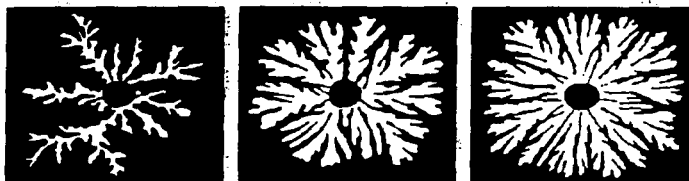
Figura 4.7: Patrones aleatorios generados en una celda de Hele-Shaw con cristal líquido como fluido viscoso para obtener aleatoriedad de forma natural. Con presión baja en la inyección de nitrógeno gaseoso se obtienen patrones análogos a los cúmulos ALD, con un salto a una morfología casi homogénea para altas presiones de inyección.
