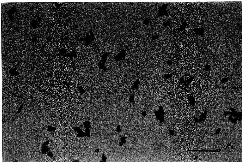
Fotomicrografía No. 29 b. Partículas libres de magnetita, en el producto de partículas de un rango de tamaño entre 10 y 15 micrómetros.
