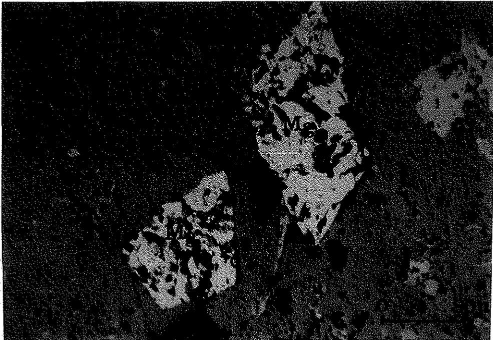
**Fotomicrografia No. 8.** Magnetita masiva (Mg) con una vetilla de calcita (mineral transparente (MT) ).
