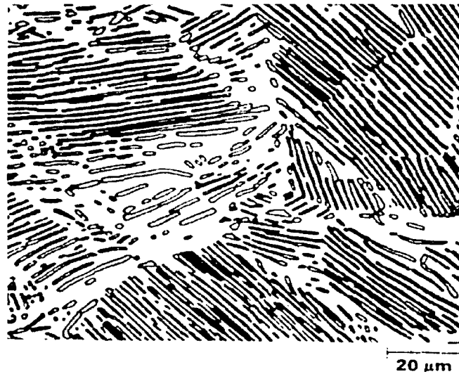
Fotografía 1. Perlita. Tomado de Metals Handbook, 9ª ed., Vol. 9: Metallography and Microstructures, American Society for Metals, Metals Park, Ohio, 1985.
