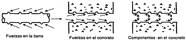
Figura 13. Esquema de fuerzas entre acero y concreto
