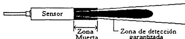
Figura 4.5 Zona Muerta en un Sensor Ultrasónico
