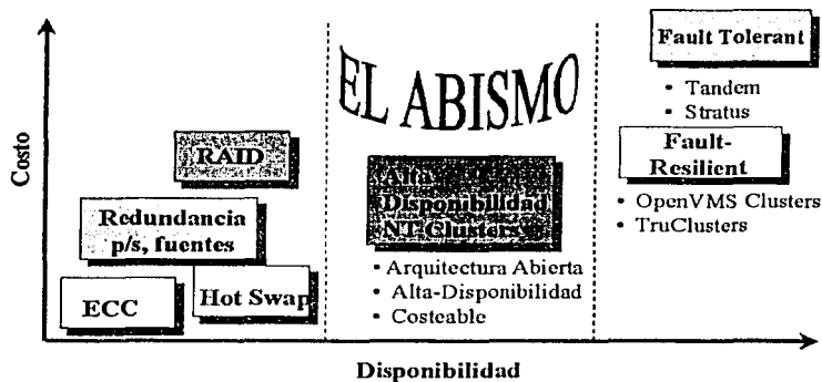
Figura 1.3 - Soluciones de alta disponibilidad, fault-resilient y fault-tolerance
