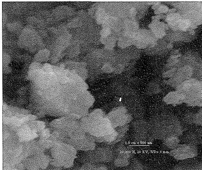
(5)  $\text{Al}_2\text{O}_3$ -pH10-  $\text{NH}_4\text{OH-II}$  20,000 x, 20 KV ,1.8 cm=500 nm
