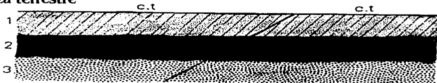
f) Falla inclinada
