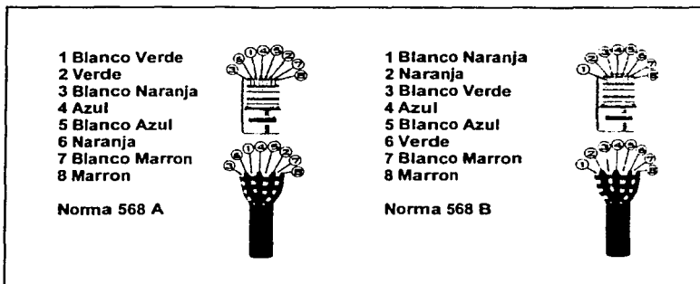
Figura 5. Cable de cobre UTP y su codificación normalizada.
