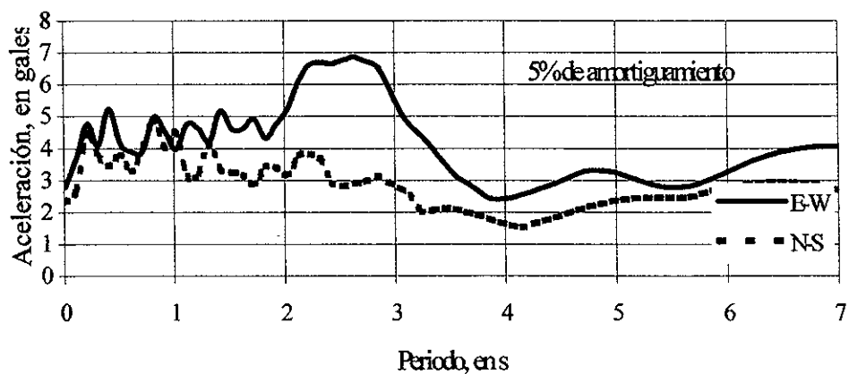
Figura 3.3.2 Espectros de respuesta de aceleraciones para el sismo del 30/Sept/99 en la superficie de la estacin TXCR (San Miguel de Tlaixpan, Texcoco)
