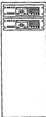
Gabinete con dos módulos M-3425 de la segunda compañía
