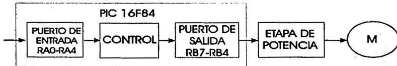
Figura 4.3 diagrama a bloques del circuito de control con microcontrolador pic 16F84
