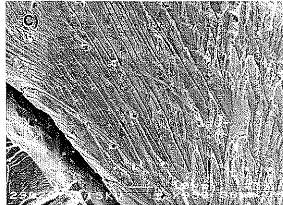
Figura 4.4 Superficie de fractura del material Fe-Al40+0.1at.%B deformado mediante forja a 700^\circ\text{C} . a) fractura de tipo intergranular predominante y transgranular en algunas zonas, b) Trazas de deslizamiento con algunos poros, c) Trazas de deslizamiento mostradas con más detalle.
