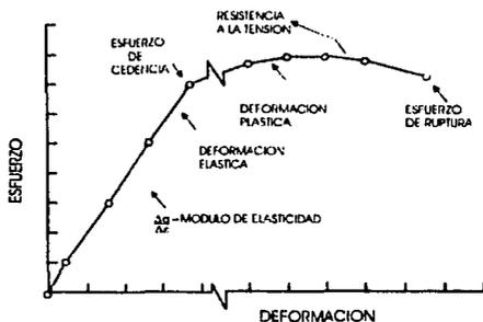
Fig. 3.1.- Gráfica Esfuerzo vs. Deformación
