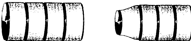
Fig. 1.12 DIABLOS DE LIMPIEZA.- Con discos de Poliuretano en cada extremo.
