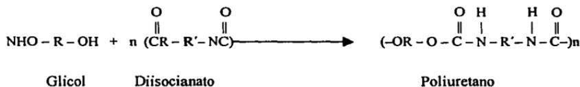
La estructura del poliuretano segmentado se logra por reacción de los diisocianatos con glicoles de cadena larga que generalmente son poliésteres o poliéteres de peso molecular entre 1000 y 2000. Después, al producto se le alarga la cadena o se acopla mediante el empleo de un glicol, una diamina o tal vez con agua. Así se obtiene el polímero final que se convierte en fibras mediante hilado en seco. En la fibra terminada las cadenas están
