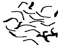
Hierro gris sin inocular demostrando un centro de nucleación
