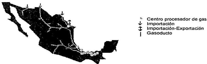
Figura 5.1 Sistema Nacional de ductos
